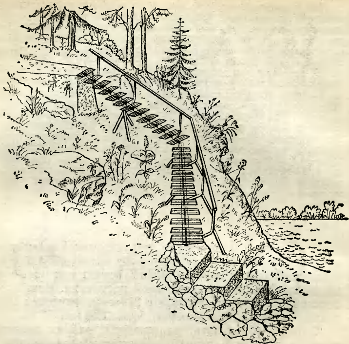
Рис. 7. Оборудование противэрозионного спуска к реке
